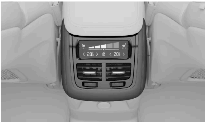
Bedieningselementen voor het klimaatsysteem op de tunnelconsole
