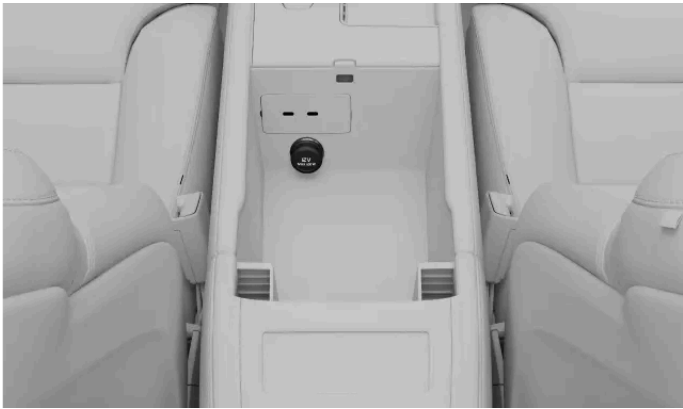
De 12V-aansluiting in de tunnelconsole
