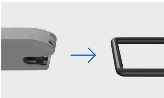
Bevestiging aan een ISOFIX-verankeringspunt
