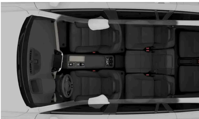
Zijairbags voor de inzittenden voorin.
