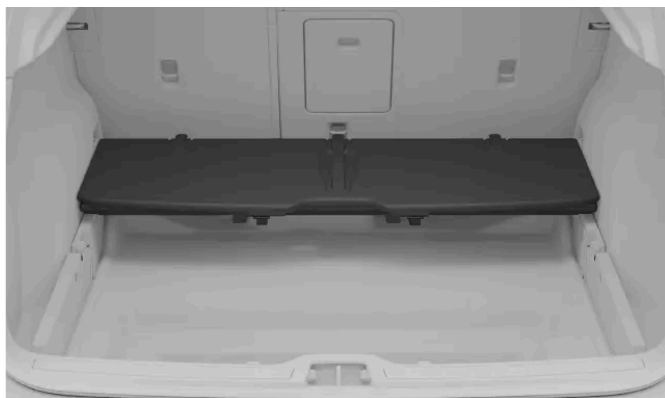
Sammenfelt luke i bagasjeromsgulvet.
