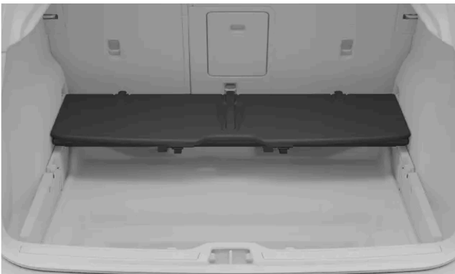
Sammenfelt luke i bagasjeromsgulvet.
