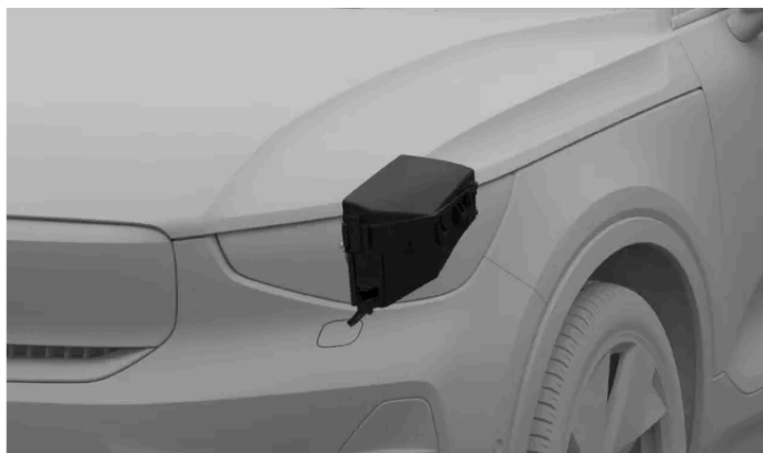
Plassering av sikringskap
