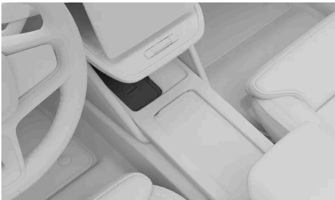
Kortleseren mellom forsetene er også bilens trådløse lader.
