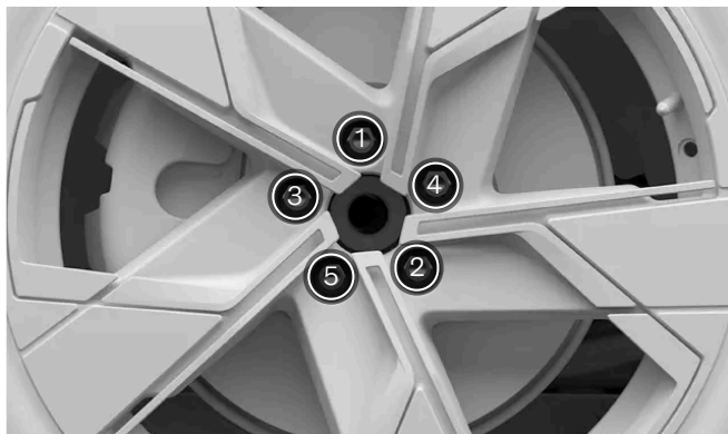
Trekk til hjulets festemateriell i et kryssmønster.
