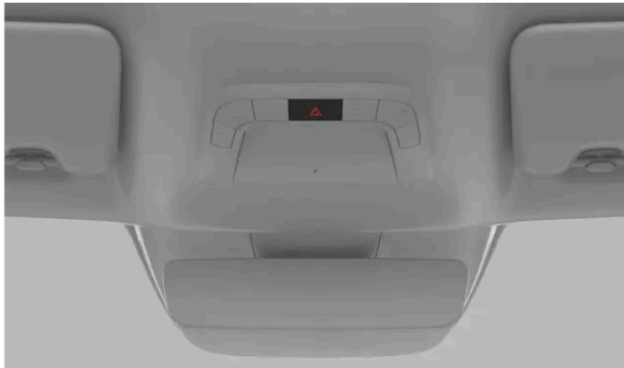
Plasseringen til knappen for nødblinsky i takkonsollen
