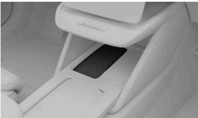
Nøkkelleseren mellom forsetene fungerer også som trådløs lader.
