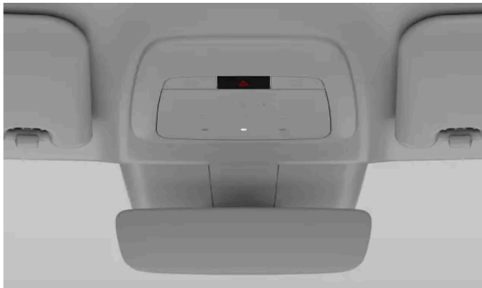
Plasseringen til knappen for nødblinklys i takkonsollen.
