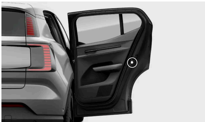
Bryterposisjon for barnesikring.
