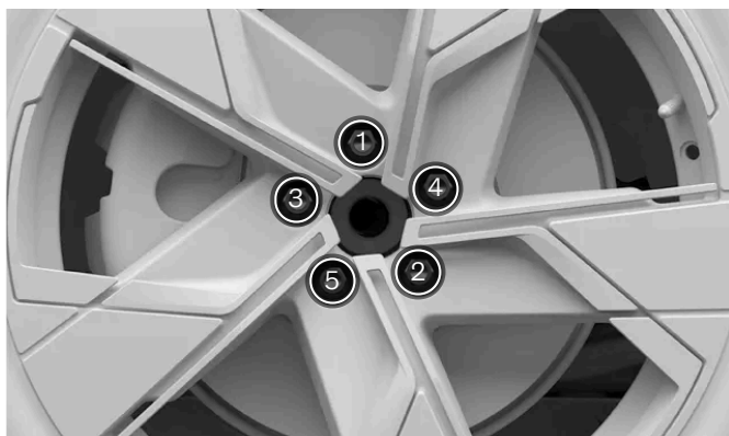
Trekk til hjulets festemateriell i et kryssmønster.
