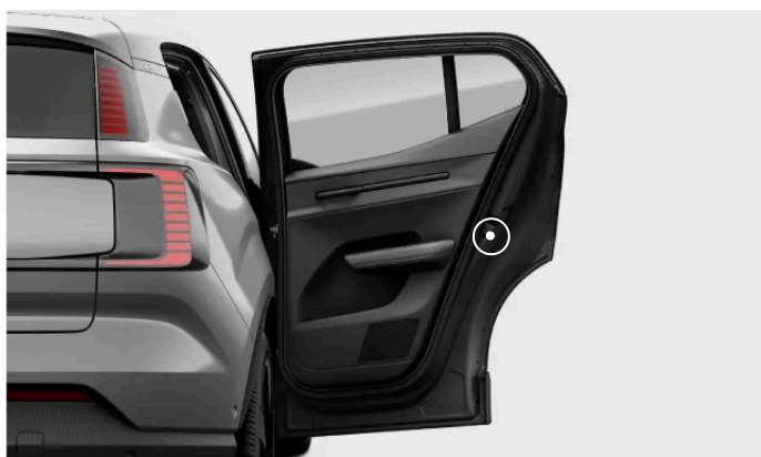
Bryterposisjon for barnesikring.
