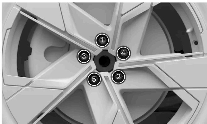
Trekk til hjulets festemateriell i et kryssmønster.
