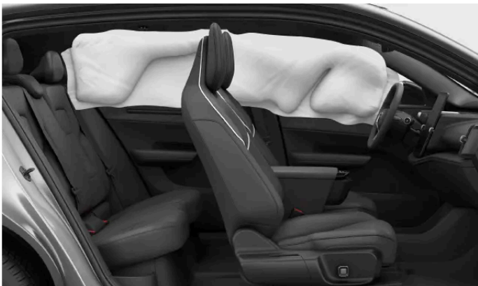
Kollisjongardin utløst på den ene siden av bilen.
