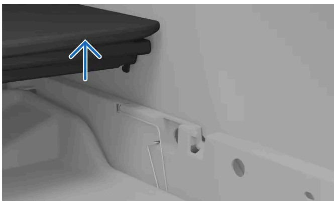
Luken i bagasjeromsgulvet frigjort.
