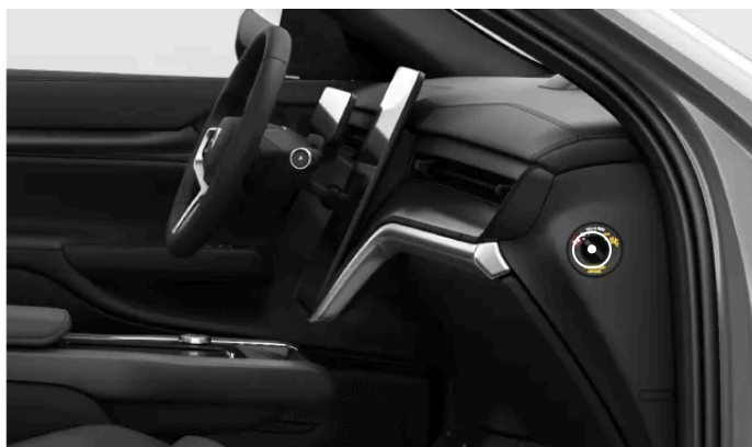
Plassering av bryter for passasjerkollisjonspute
