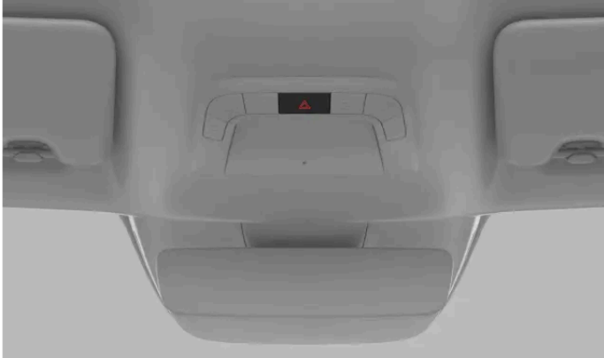
Plasseringen til knappen for nødblinsklys i takkonsollen
