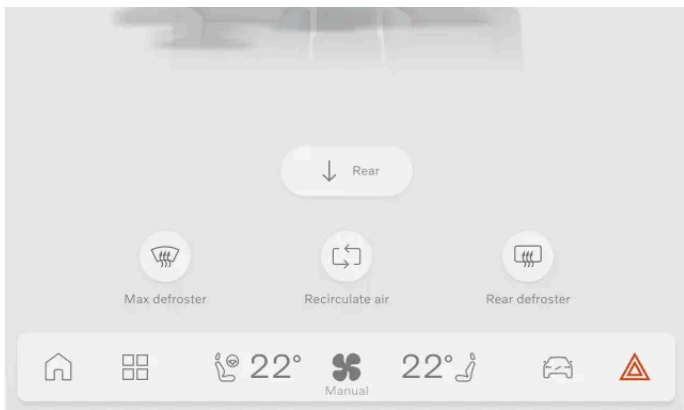
Plasseringen til knappen for nødblinsklys i midtdisplayet
