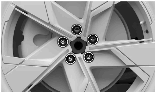
Trekk til hjulets festemateriell i et kryssmønster.
