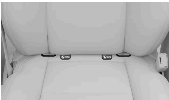
Plassering av ISOFIX-festepunkter for passasjeretset foran
