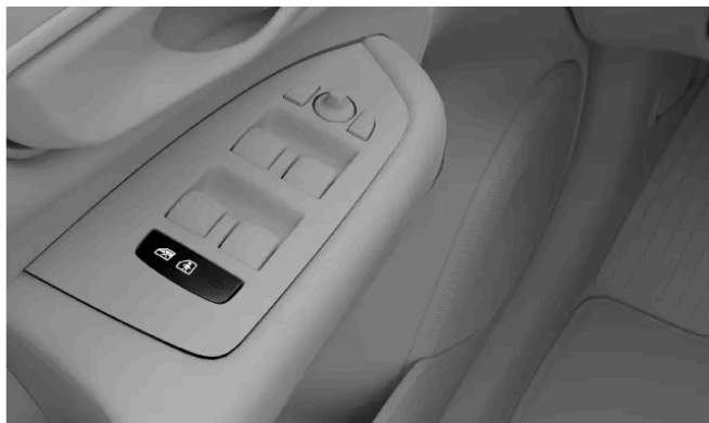
Plassering av barnesikringsknappen i dørpanelet
