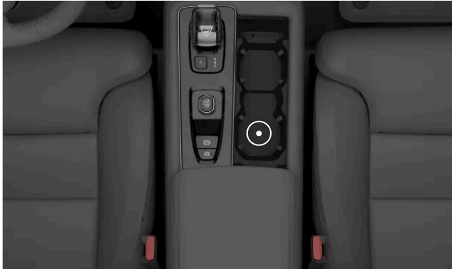
Plassering av sikkerhetskopileseren i koppholderen i midtkonsollen
