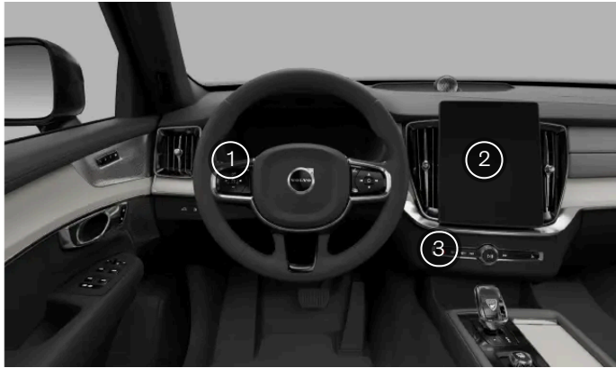
Plassering av kontroller for utvendig belysning
