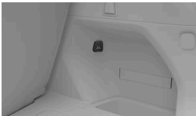
Strømuttaket på 12 V er plassert på høyre side i bagasjerommet
