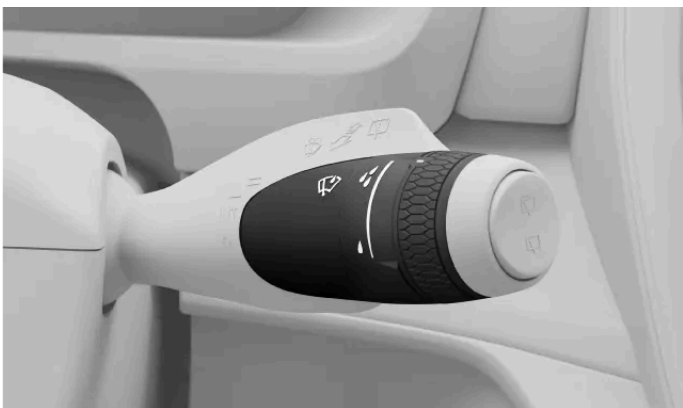
Kontrollene for viskerne foran sitter på høyre ratthendel.
