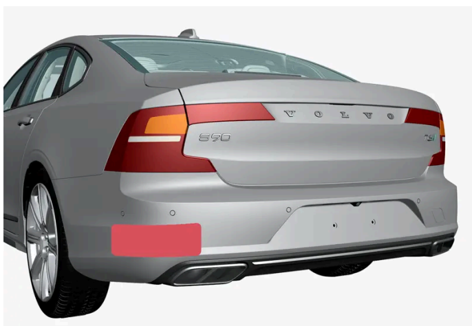
Plassering av bakre radarenheter
