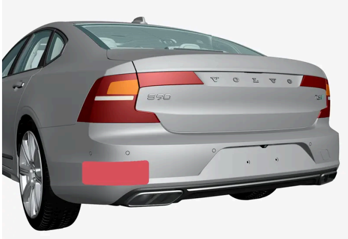
Plassering av bakre radarenheter
