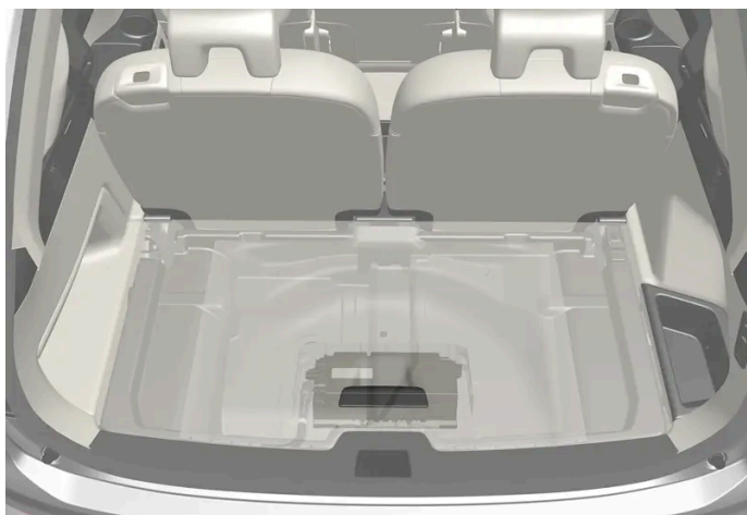
Biler av typen mildhybrid har et 48-volts hjelpebatteri plassert under bagasjerommet. Batteriet og boksen rundt må bare håndteres av et autorisert verksted.
