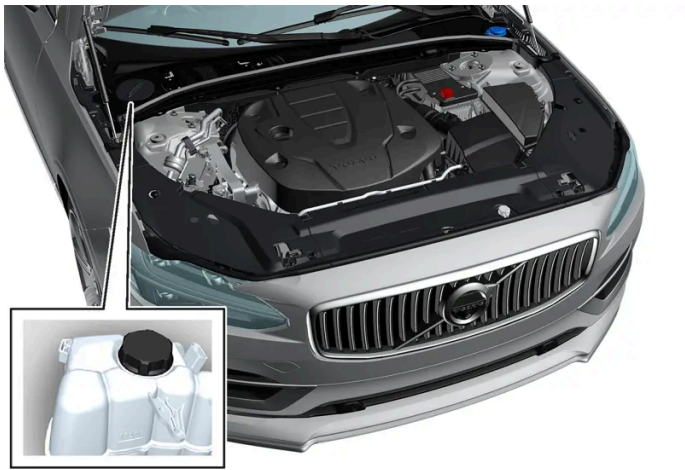
Ekspansjonsbeholder for kjølesystemet, bil med venstrerett.
