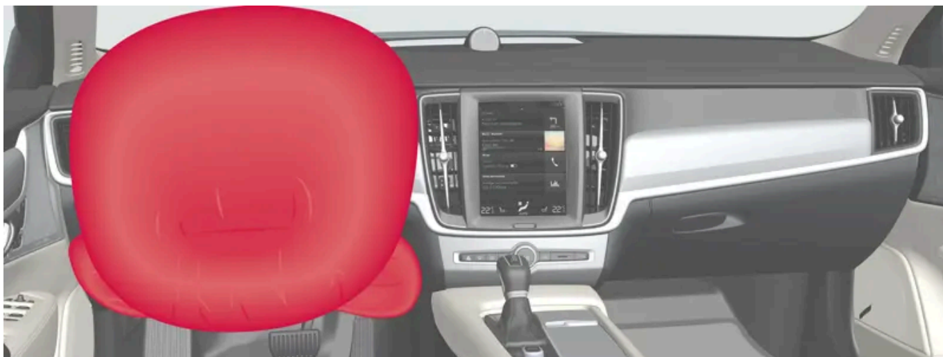
Rattkollisjonspute og knekollisjonspute [1] på førersiden i forsetet.
