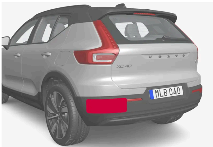
Plassering av bakre radarenheter
