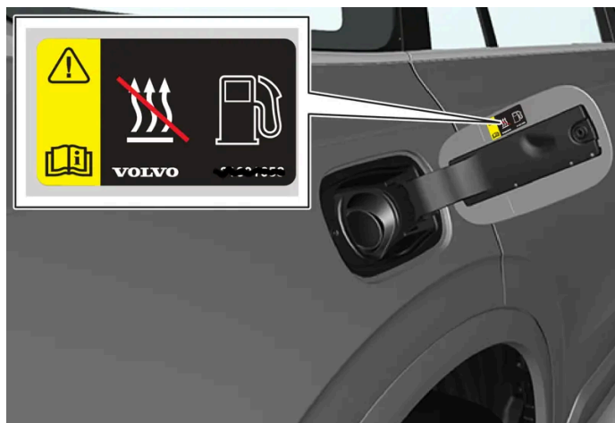
Varselmerke på tanklokkkluken.
