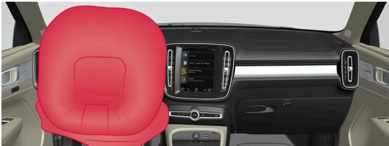
Rattkollisjonspute og knekollisjonspute [1] på førersiden i forsetet.
