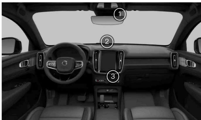
Czujniki klimatyzacji we wnętrzu
