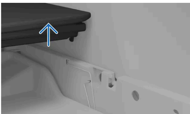
Kłapa wnęki pod podłogą bagażnika zwolniona.
