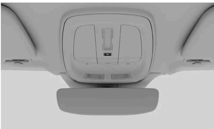
Przycisk automatycznego wyłączania oświetlenia na konsoli sufitowej
