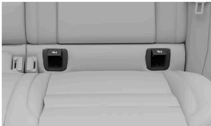
Rozmieszczenie punktów mocowania ISOFIX dla bocznych tylnych siedzeń
