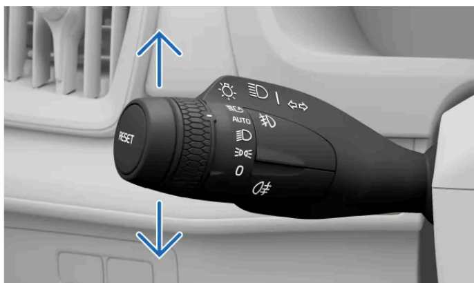
Wskaźniki na lewej dźwigni
