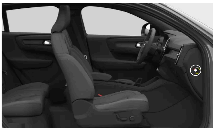
Położenie przełącznika poduszki powietrznej pasażera
