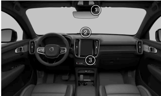
Czujniki klimatyzacji we wnętrzu
