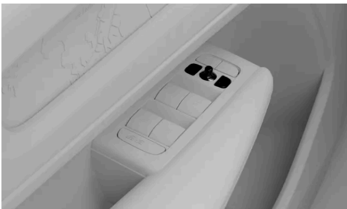
Elementy sterujące regulacją lusterek bocznych
