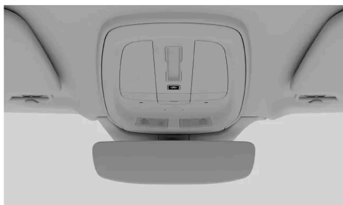
Przycisk automatycznego wyłączania oświetlenia na konsoli sufitowej
