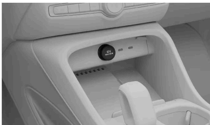
Gniazdo elektryczne 12 V na konsoli między fotelami
