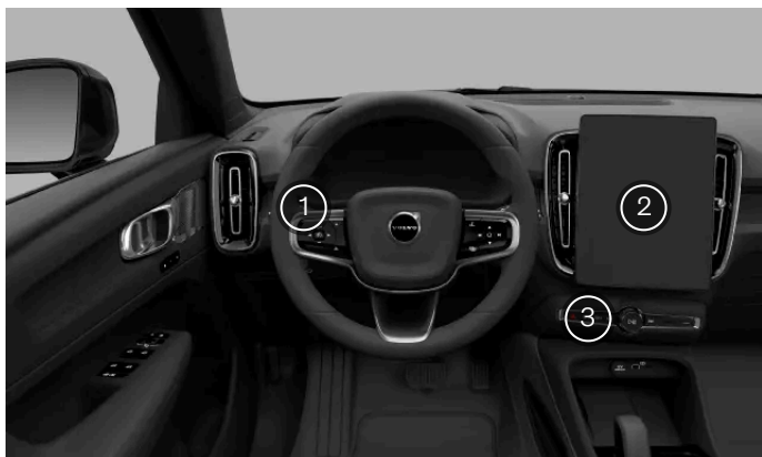
Rozmieszczenie elementów sterujących światłami zewnętrznymi
