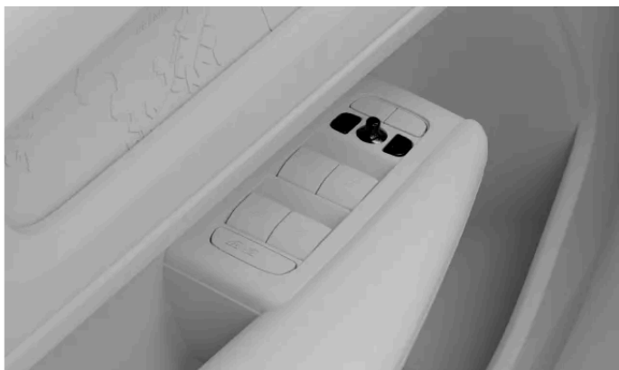
Elementy sterujące regulacją lusterek bocznych
