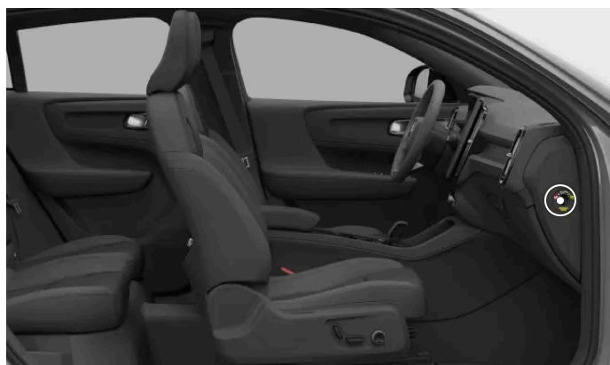
Położenie przełącznika poduszki powietrznej pasażera
