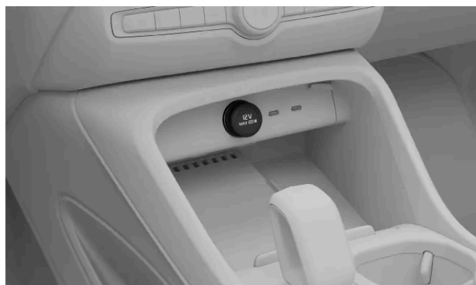
Gniazdo elektryczne 12 V na konsoli między fotelami
