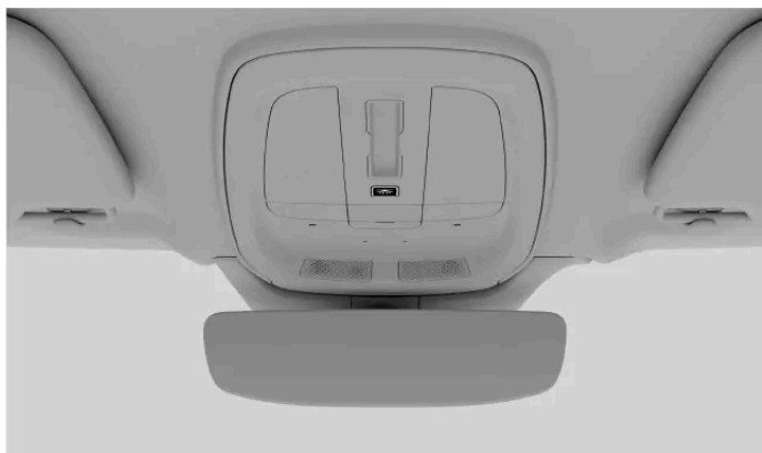
Przycisk włączania pełnego oświetlenia na konsoli sufitowej
