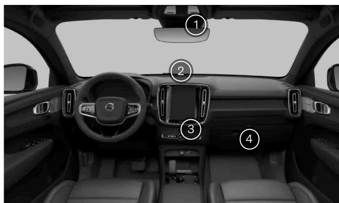
Czujniki klimatyzacji we wnętrzu
