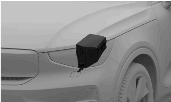
Położenie skrzynki bezpieczników
