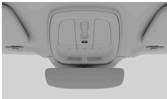
Przycisk automatycznego wyłączania oświetlenia na konsoli sufitowej
