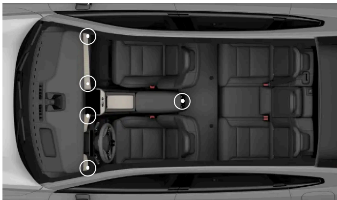
Rozmieszczenie regulowanych nawiewów
