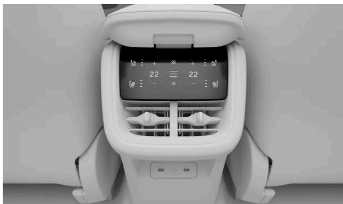
Elementy sterujące klimatyzacją na konsoli między fotelami
