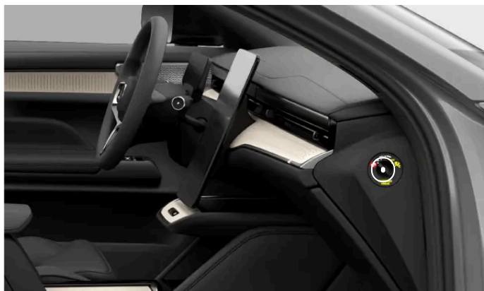
Położenie przełącznika poduszki powietrznej pasażera
