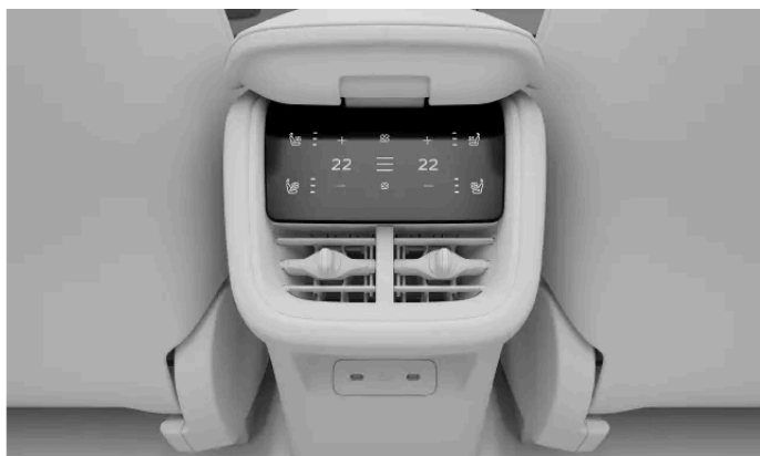
Elementy sterujące klimatyzacją na konsoli między fotelami
