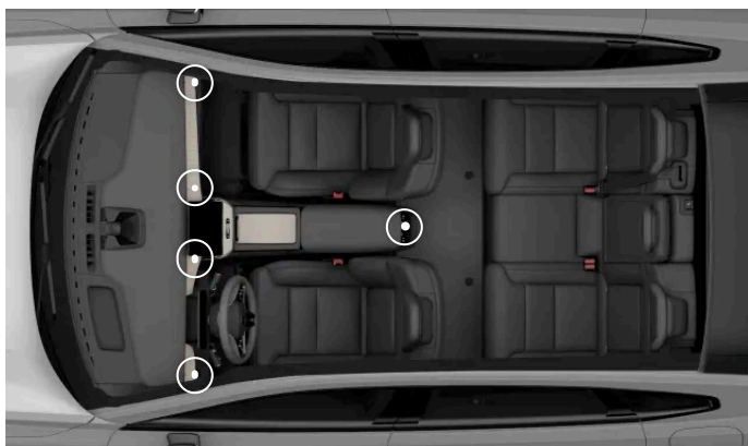
Rozmieszczenie regulowanych nawiewów
