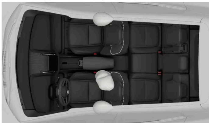
Poduszki powietrzne chroniące kierowcę i pasażera z przodu w razie zderzenia bocznego.
