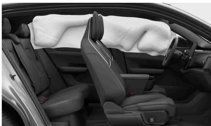
Kurtyna powietrzna rozwinięta po jednej stronie samochodu.
