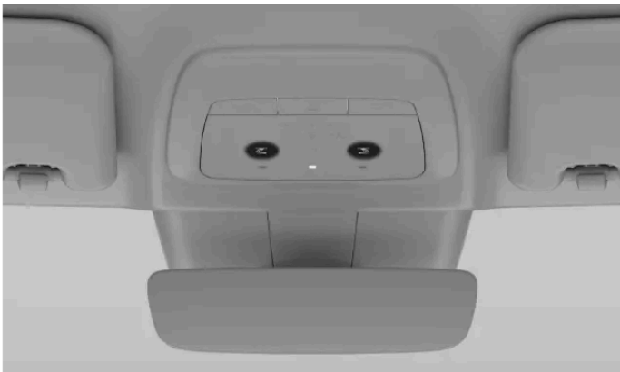
Lampki do czytania dla foteli przednich są w konsoli sufitowej
