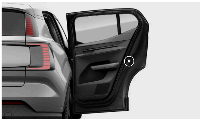
Położenie przełącznika blokady tylnych drzwi.
