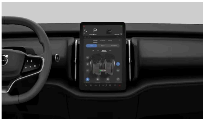
Elementy sterujące klimatyzacją na wyświetlaczu
