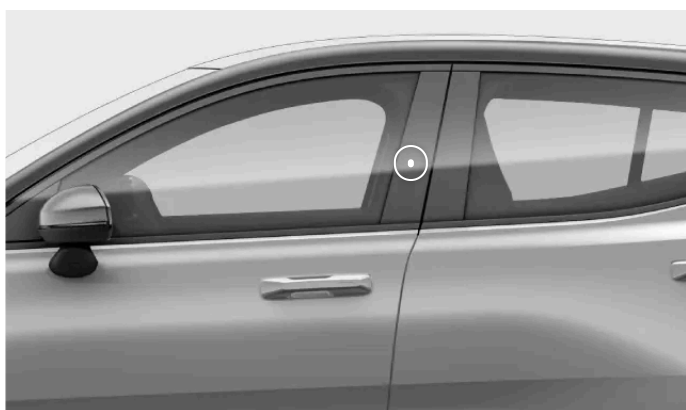
Obszar wykrywania kluczyka na słupku drzwiowym po stronie kierowcy
