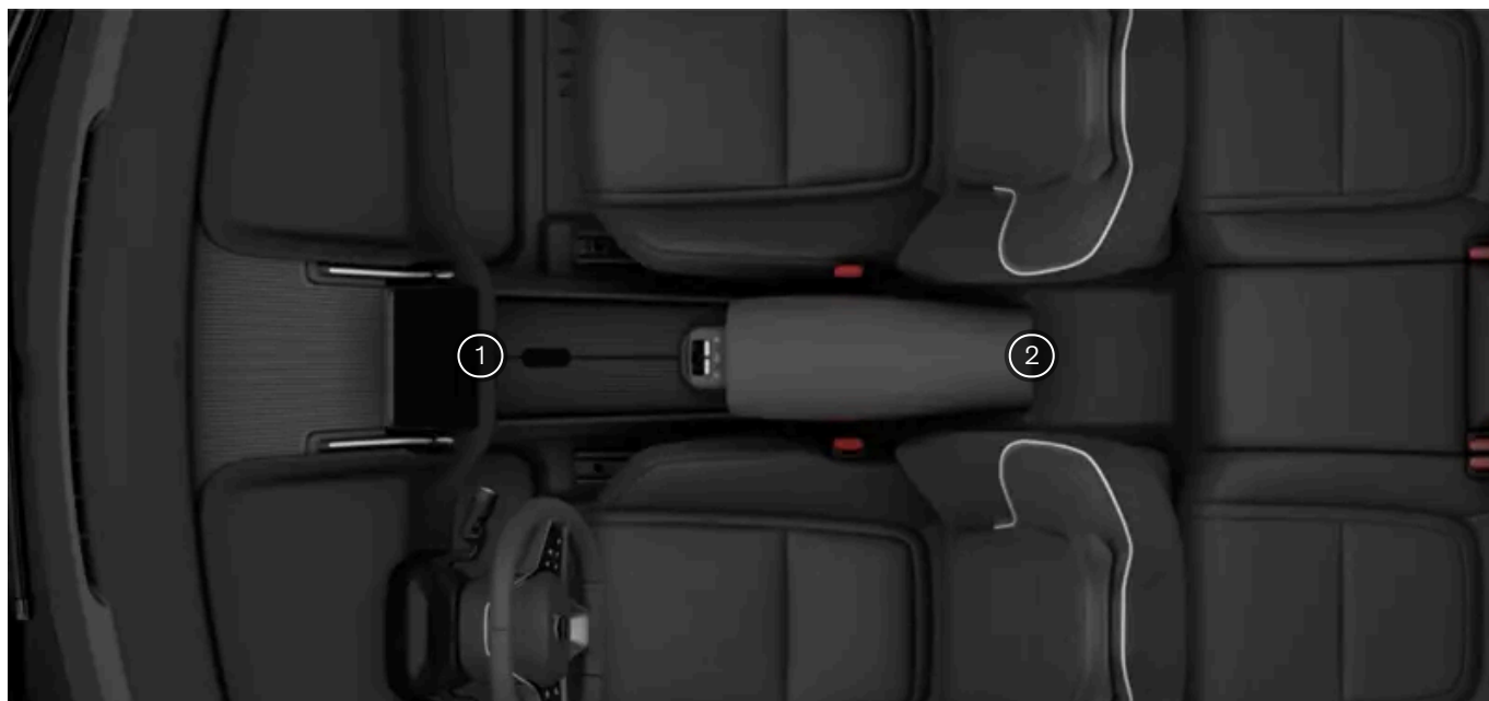
Rozmieszczenie gniazd USB.
