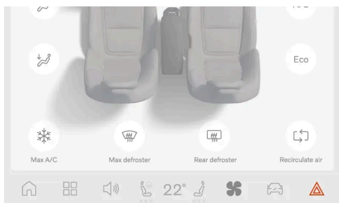
Położenie przycisku świateł awaryjnych na wyświetlaczu
