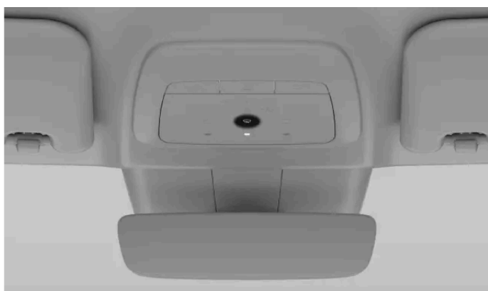
Przycisk odmrażania na konsoli sufitowej
