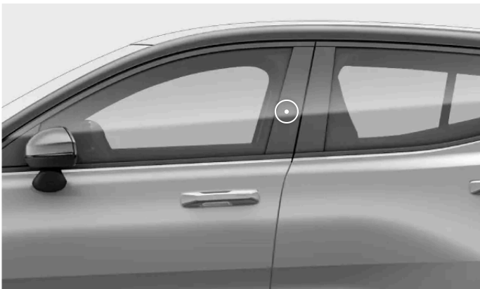
Obszar wykrywania kluczyka na słupku drzwiowym
