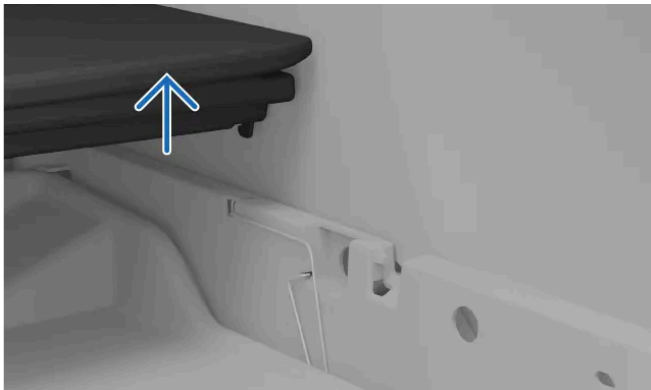
Kłapa wewnątrz pod podłogą bagażnika zwolniona.
