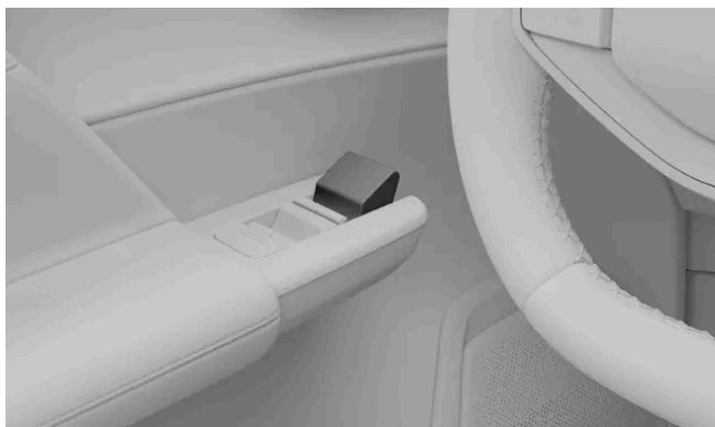
Wewnętrzna klamka drzwi przesunięta do góry do pozycji otwierania awaryjnego
