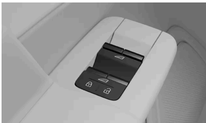
Przełączniki sterujące szybami znajdują się na drzwiach kierowcy.
