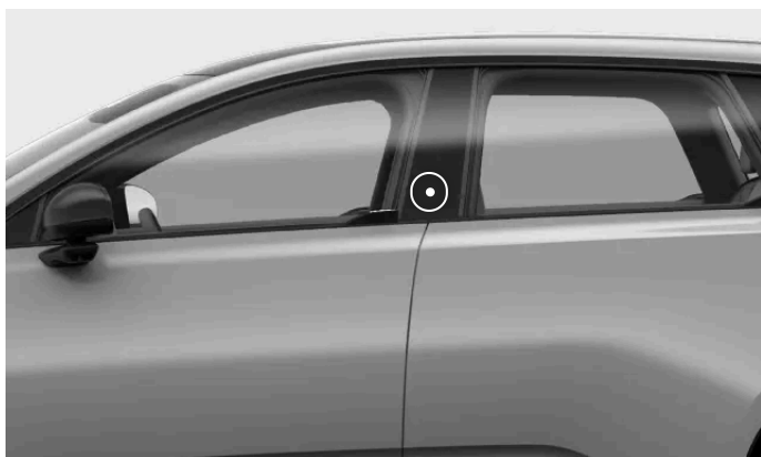
Umieszczenie czytnika kluczyka na słupku drzwiowym
