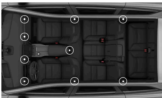
Rozmieszczenie regulowanych nawiewów
