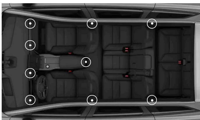
Rozmieszczenie regulowanych nawiewów
