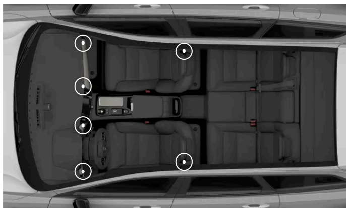
Rozmieszczenie regulowanych nawiewów
